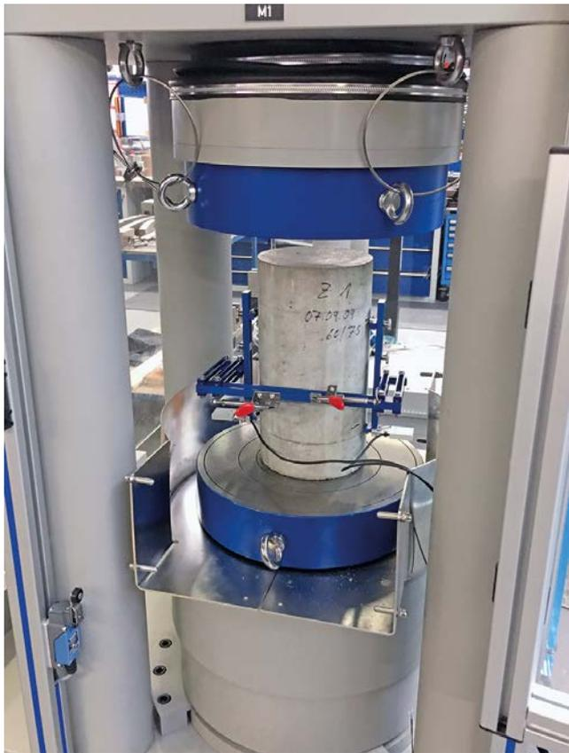
Bild 109-3: Komplett montierte Wegaufnehmereinheit in der Druckprüfmaschine (Bild: Testing)
