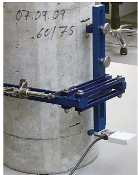
Bild 109-2: Details der Wegaufnehmer-Sensoren (Bild: Testing)
