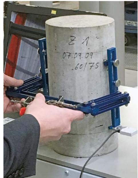
Bild 109-1: Anbringung von Sensoren an den Messlinien mit einer von vorn anzubringender Klemmvorrichtung (Bild: Testing)
